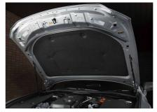
自動車 フードサイレンサーおよびエンジン周り 「吸音材・断埶材 (耐埶性)〕
